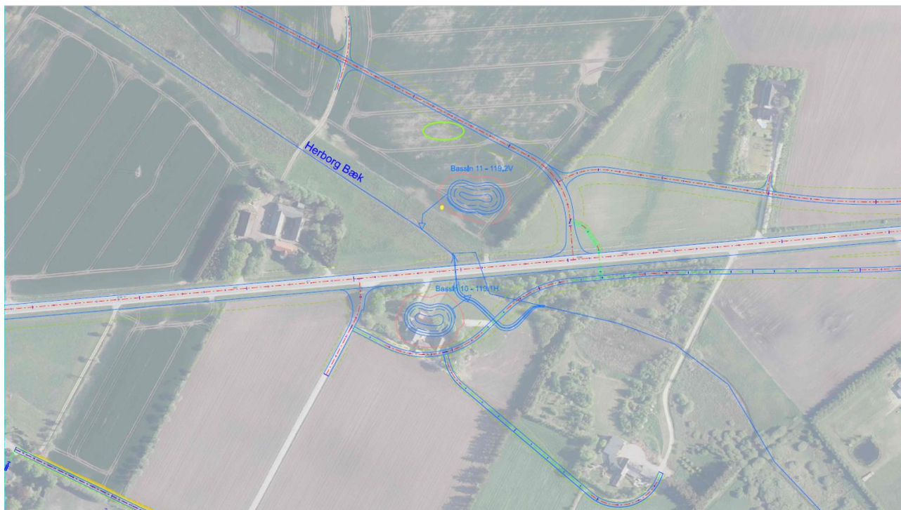
Figur 4: Udledningspunktet (grøn cirkel) for bassin 11 er valgt således, at begge ligger med en minimumsafstand på 50 meter til nærmeste vandløb. På figuren ses det, at udledningspunktet ligger ca. 75 meter fra vandløbet. Udledningspunkterne er placeret, hvor grundvandsspejlet står lavest, og hvor jordtypen består af lerblandet sandjord, så man skal helst vælge et område med lavest grundvandsstand for at minimere risikoen for lokal oversvømmelse bedst muligt. Den gule markering angiver den planlagte placering af prøveboringen.
